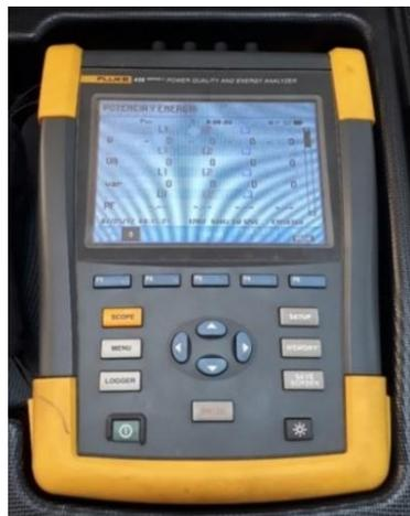
**Figura 4-9.** Analizador de energía (Fluke 435-II)
