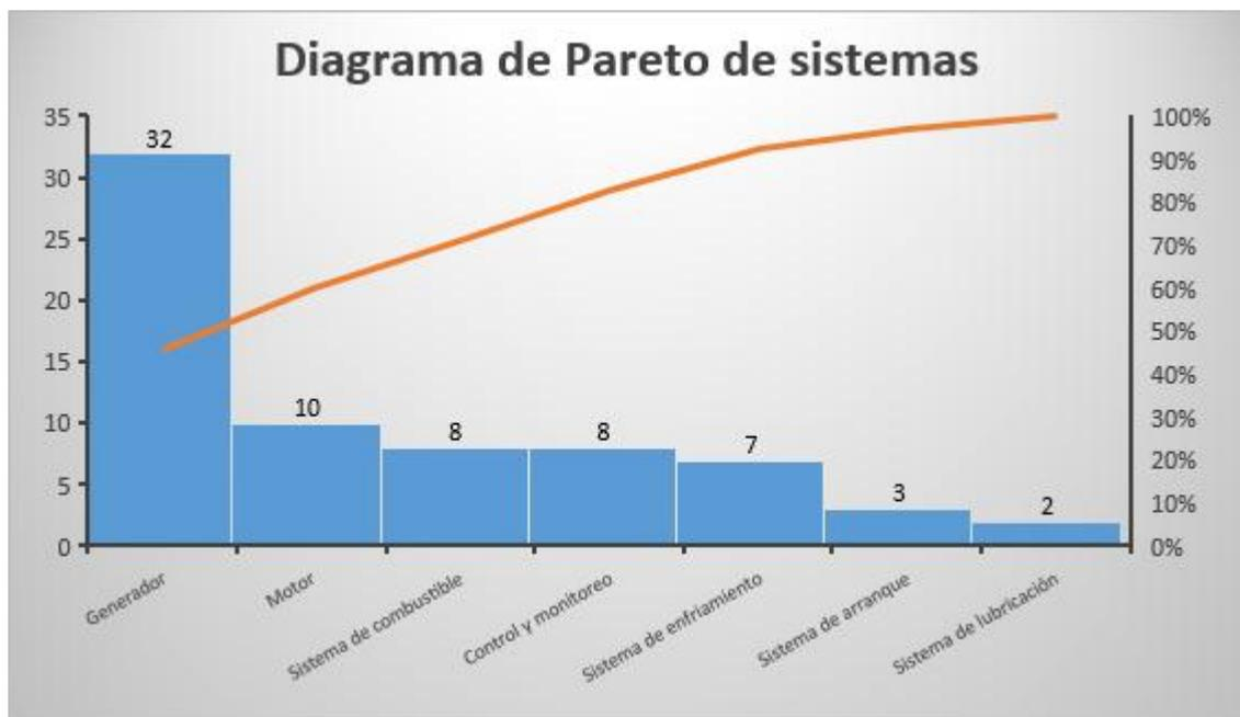
**Figura 4-11.** Fallas por sistemas de los generadores
