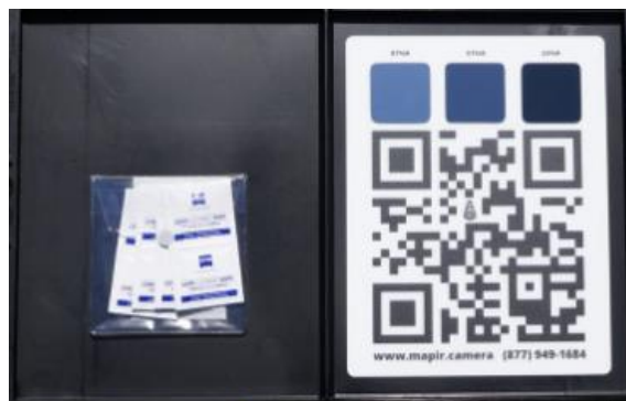
Figura 21-3: Tarjetas calibradas de reflectancia.
