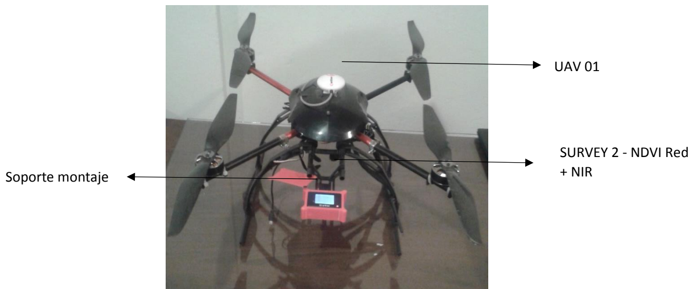
Figura 1-4: Adaptación soporte cámara - UAV 01.
