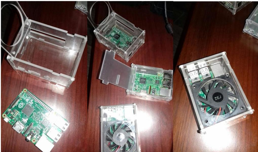
**Figura 15-2** Colocación del dispositivo Raspberry Pi y ventilador en su carcassa.
