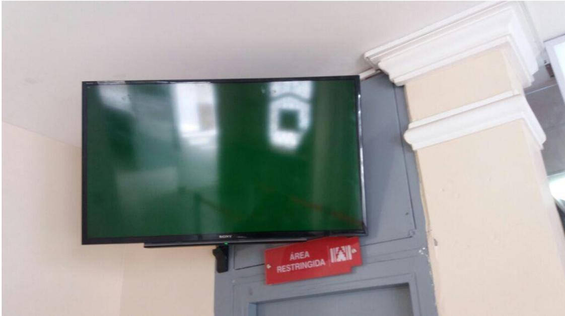
**Figura 62-3** Visualización de video con errores, salida de video en pantalla verde con audio.
