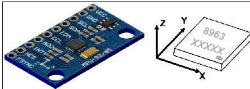
**Figura 15-2.** Ejes del magnetómetro AK8963 MPU-9250
