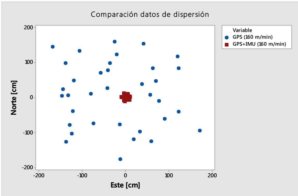
**Gráfico 8-3.** Comparación de dispersión de puntos (GPS, GPS+IMU 160 m/min)
