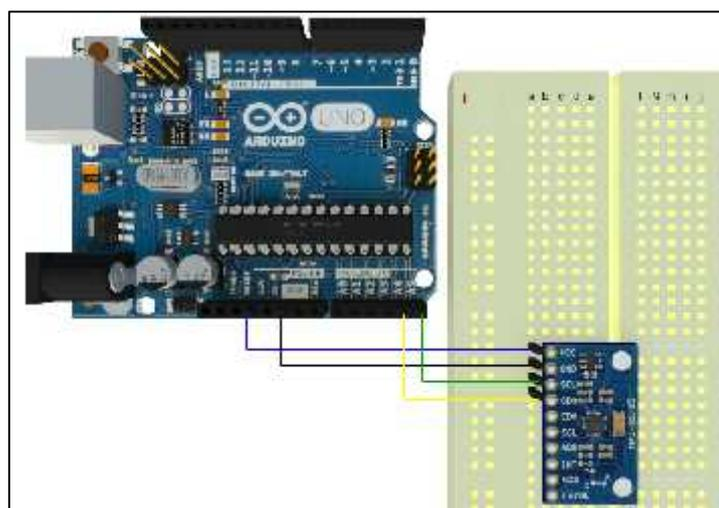
**Figura 7-2.** Conexión MPU 9250
