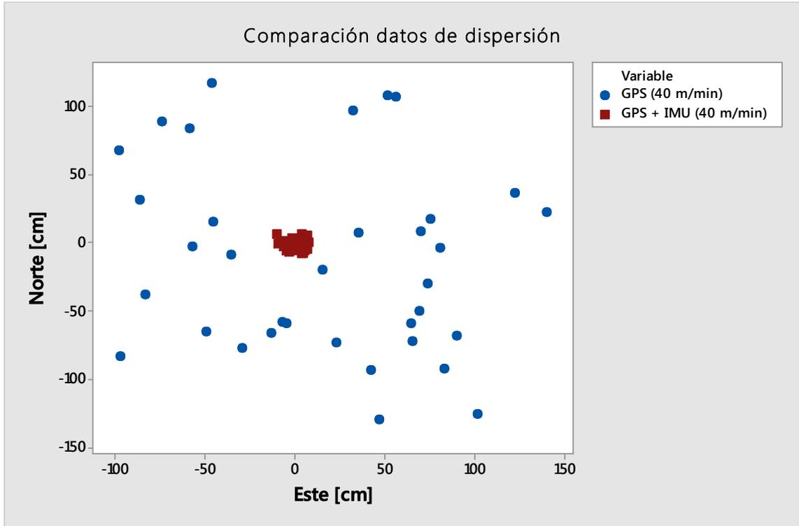
**Gráfico 7-3.** Comparación de dispersión de puntos (GPS, GPS+IMU 40 m/min)
