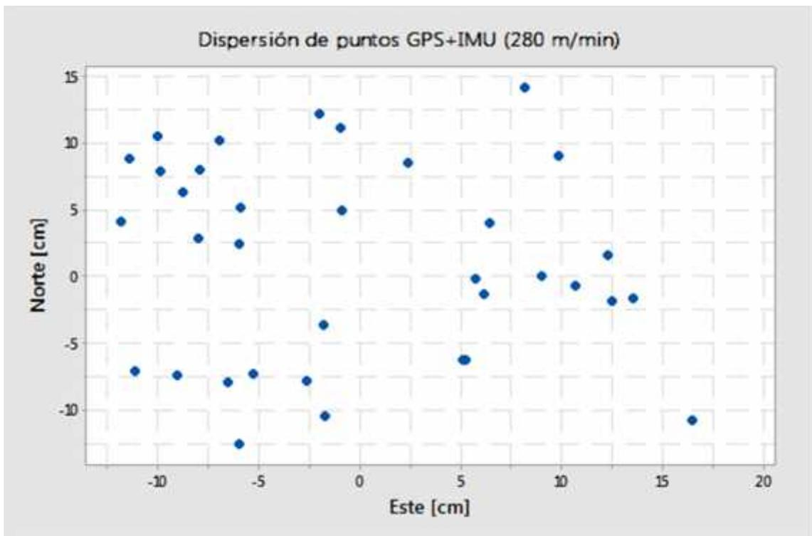
**Gráfico 6-3.** Dispersión de puntos GPS+IMU (280 m/min)
