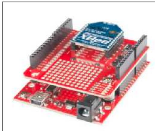
**Figura 11-1.** Conexión módulo XBee con Arduino mediante Shield
