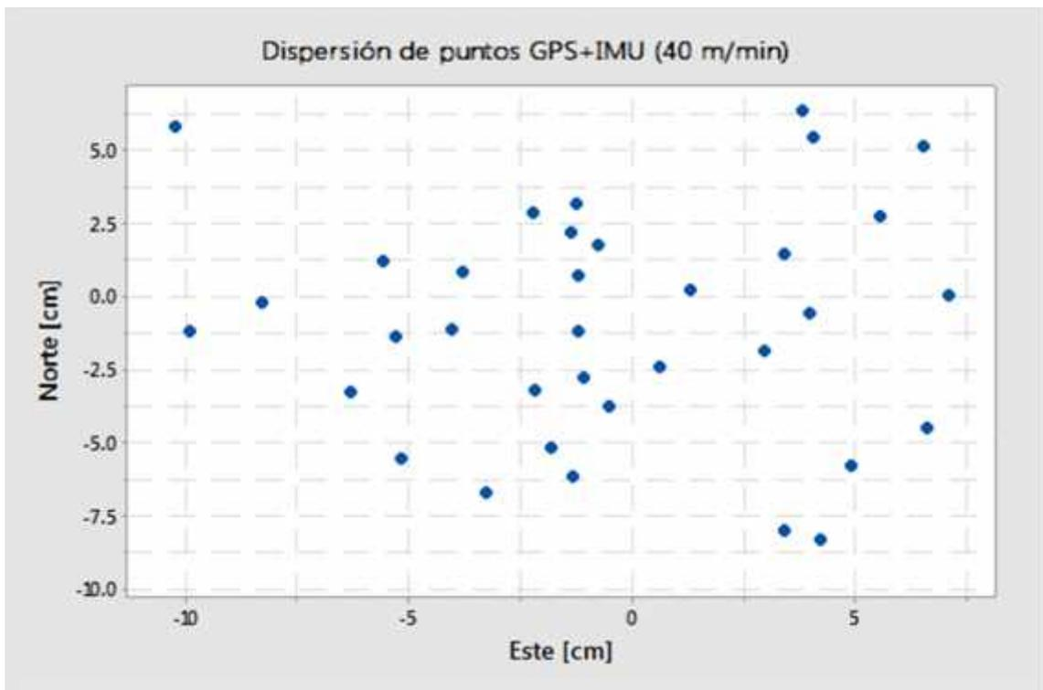
**Gráfico 4-3.** Dispersión de puntos GPS+IMU (40 m/min)
