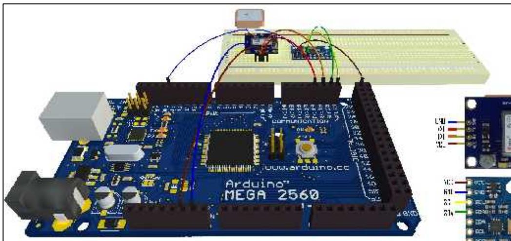
**Figura 19-2.** Conexión dispositivos
