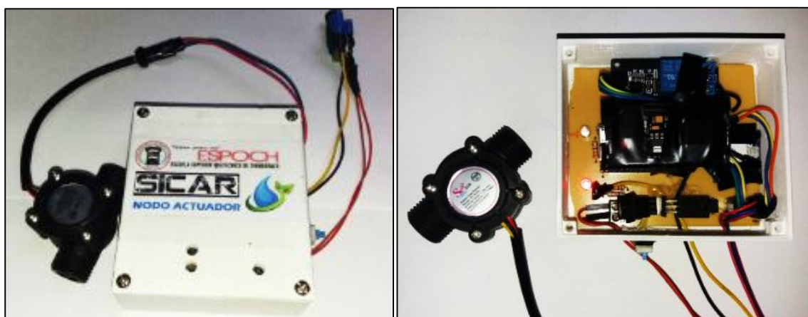
Figura 11-3 Prototipo del Nodo Actuador, vista externa (izquierda) y vista interna (derecha)
