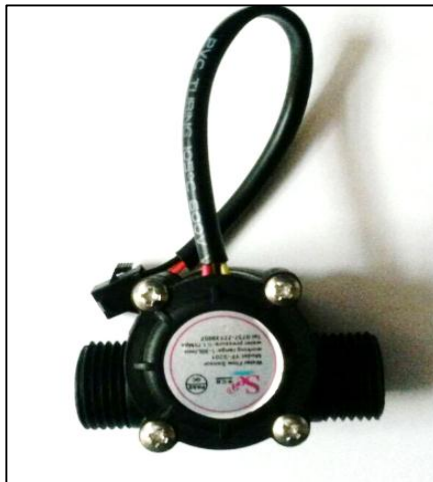
Figura 13-2 Sensor de flujo de agua Realizado por: PAREDES, Marjorie, 2017
