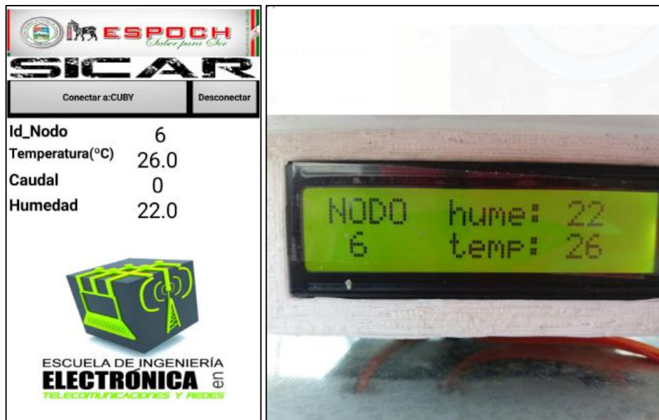
Figura 16-3 Monitoreo en la aplicación móvil (izquierda), y visualización en el nodo sensor (derecha).
