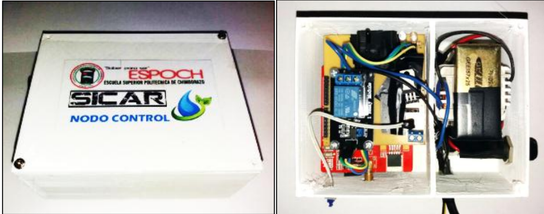
Figura 14-3 Prototipo del Nodo Control, vista externa (izquierda) y vista interna (derecha) Realizado por: PAREDES, Marjorie, 2017
