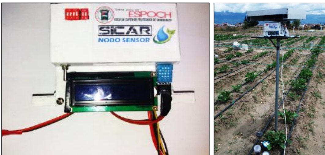
Figura 4-3 Prototipo del Nodo Sensor (izquierda), alimentación solar del nodo (derecha) Realizado por: PAREDES, Marjorie, 2017
