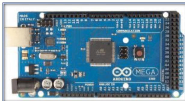
**Figura 17-1:** Placa Arduino Mega
