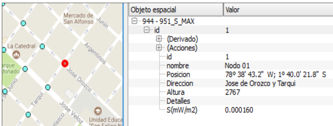
Figura 22-3: Valor de Densidad de Potencia Máximo del nodo 1 Realizado por: Huilca, J. 2017
