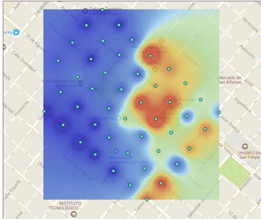
Figura 27-3: Mapa de Interpolación de Intensidad de Campo Eléctrico Promedio del nodo 1 Realizado por: Huilca, J. 2017
