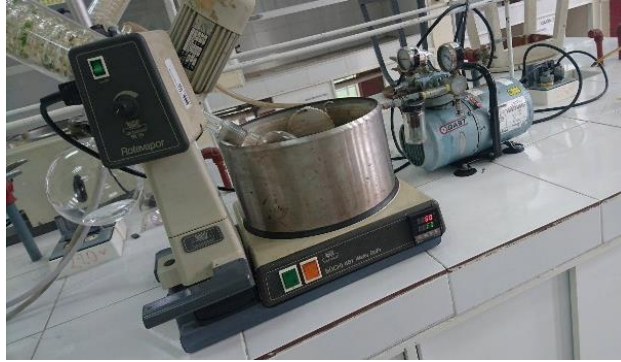
FOTOGRAFÍA 2B. Evaporación del solvente en rotavapor.
