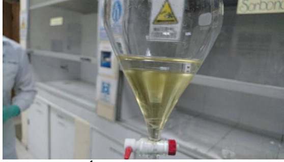
FOTOGRAFÍA 5B. Extracción de alcaloides con acetato de etilo.
