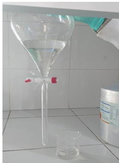
FOTOGRAFÍA 4B. Desengrasado del extracto bruto ácido.
