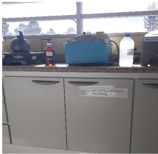
Figura 31-3: Falta de señalización en el almacenamiento de sustancias peligrosas.
