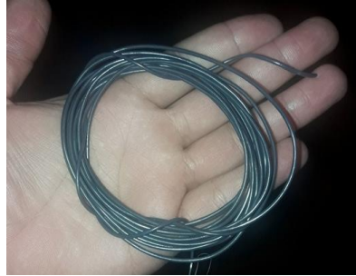
Figura 87-3. Resultado de la extrusión a 165 °C, filamento con buena calidad
