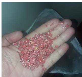
Figura 81-3. Trozos de LDPE utilizados en la extrusora
