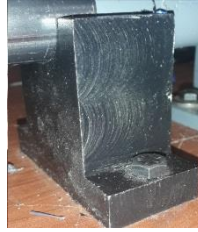
Figura 53-3. Base de Apoyo Cilindro fabricada
