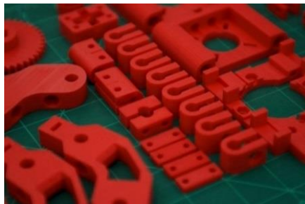
Figura 16-2. Piezas impresas en 3D con material ABS
