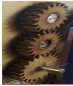
Figura 63-3. Piñón Motor DC de 24v y rueda dentada de ejes tensores fabricados
