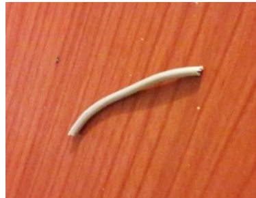
Figura 85-3. Resultado de la extrusión a 260 °C, filamento regular pero muy frágil
