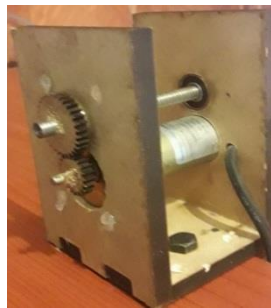
Figura 64-3. Base de Enrollamiento fabricado
