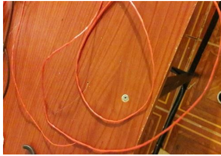
Figura 82-3. Resultado de la extrusión a 200 °C, filamento irregular
