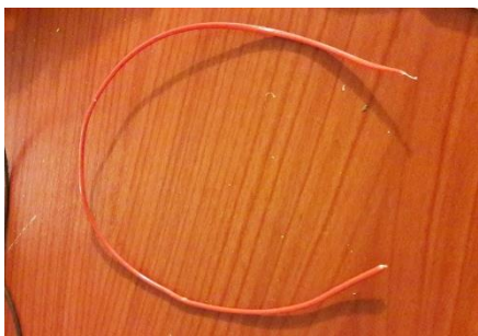
Figura 83-3. Resultado de la extrusión a 180 °C, filamento irregular
