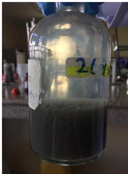
**Fotografía 11:** Colocación 1mL de Cloruro de Manganeso ( $\text{MnCl}_2 \cdot 4\text{H}_2\text{O}$  40%) y 1 mL de Acida Sódica ( $\text{NaN}_3$ ).
