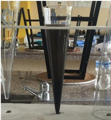
**Fotografía 14:** Cono Imhoff con una muestra de agua en el proceso de aireación de 1000 mL para pruebas de nivel de sedimentación.
