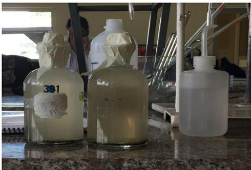
**Fotografía 9:** Botella Wheaton con una muestra de agua del tanque de aireación para la determinación de oxígeno disuelto.
