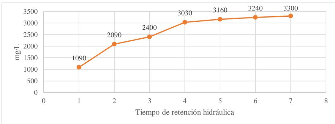
**Gráfico 13-3:** Resultados de sólidos suspendidos volátiles del reactor biológico (tanque de aireación) en el prototipo
