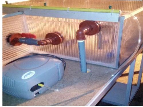
**Fotografía 22:** Instalación de sistema de aireación mediante bombas de aire unidas a difusores.
