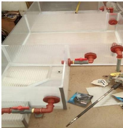
**Fotografía 19:** Construcción de la mesa metálica como base para el prototipo y armado de los tanques de policarbonato.
