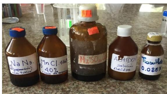
**Fotografía 10:** Reactivos para la determinación de oxígeno disuelto en el reactor biológico de lodos activados. Acida Sódica ( $\text{NaN}_3$ ), Cloruro de Manganeso ( $\text{MnCl}_2 \cdot 4\text{H}_2\text{O}$  40%), Ácido Sulfúrico ( $\text{H}_2\text{SO}_4$ ), Almidón y Tiosulfato a 0.025 N (izquierda a derecha).
