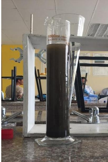
**Fotografía 17:** Colocación de 1000 mL en la probeta con una muestra del licor mezcla para la determinación de la velocidad de sedimentación.
