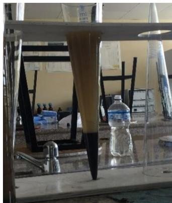
**Fotografía 16:** Determinación de la muestra a los 30 minutos en el Cono Imhoff.
