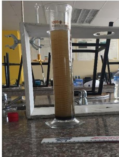
**Fotografía 18:** Determinación de la velocidad de sedimentación mediante una regla.
