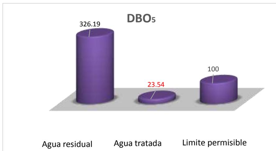
**Gráfico 7-3.** Disminución de concentración de la DBO<sub>5</sub>
