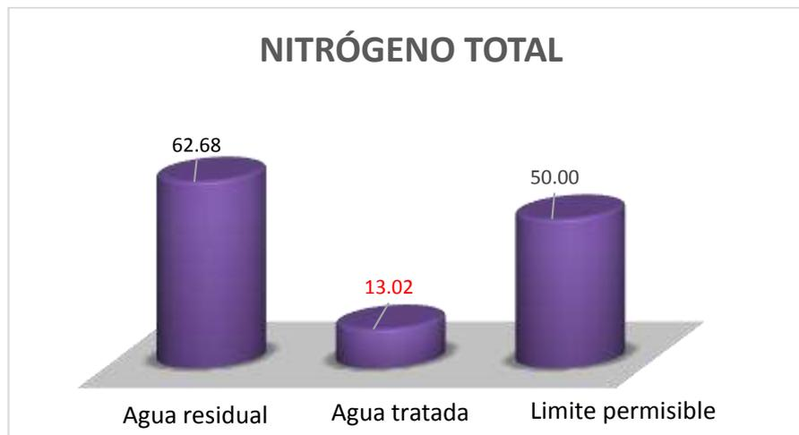
**Gráfico 5-3.** Disminución de concentración del nitrógeno total
