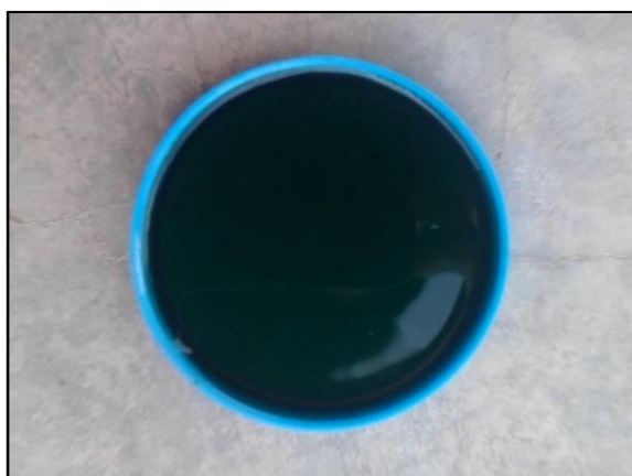
Figura 1-4: Sulfato de cromo III obtenido por lixiviación
