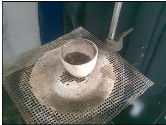
Figura 4-2: Calcinación de una muestra
