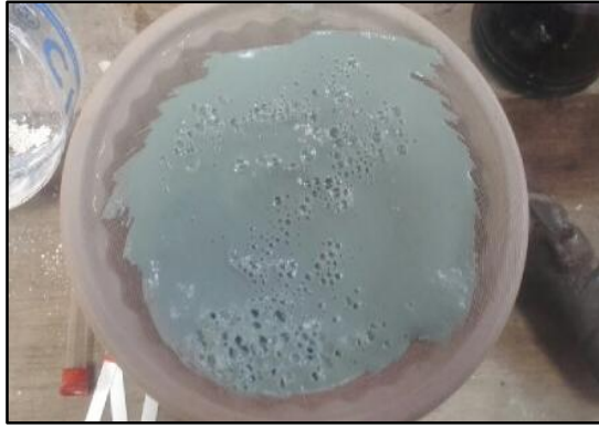
Figura 5-3: Filtrado de los lodos de cromo
