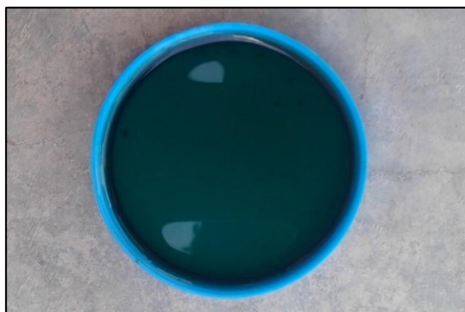
Figura 6-4: Sulfato de cromo III obtenido por calcinación/disolución
