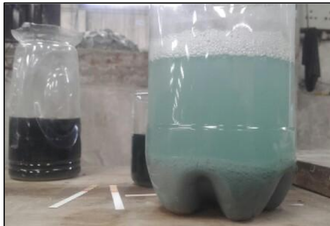
Figura 4-3: Precipitación de las aguas de curtido
