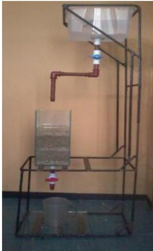
**Fotografía 1B:** Construcción del sistema de filtración
