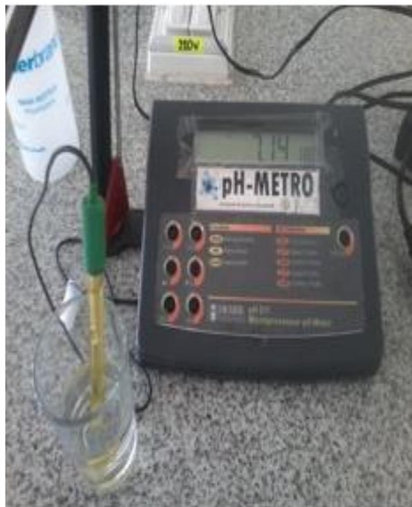
**Fotografía 3C:** Medición de pH del agua sintética
