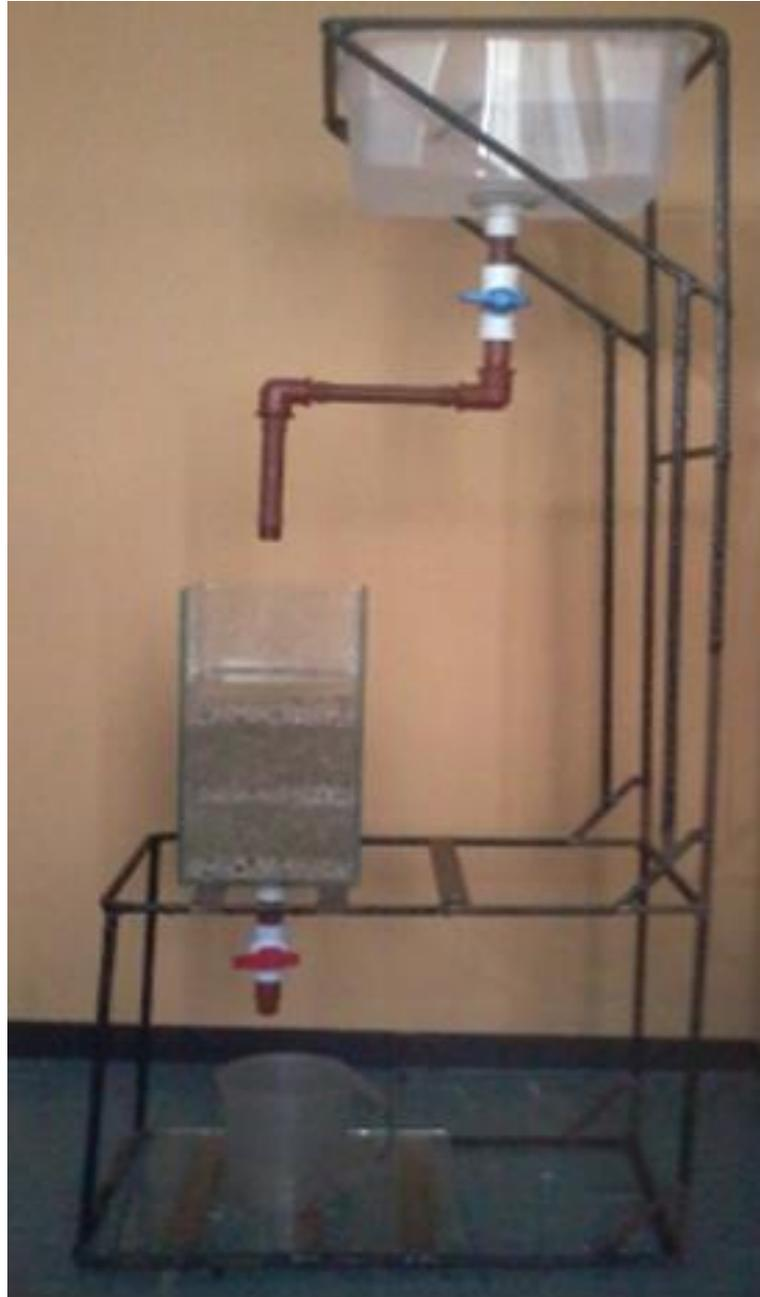
**Figura 2-2.** Diseño de biofiltro por gravedad
