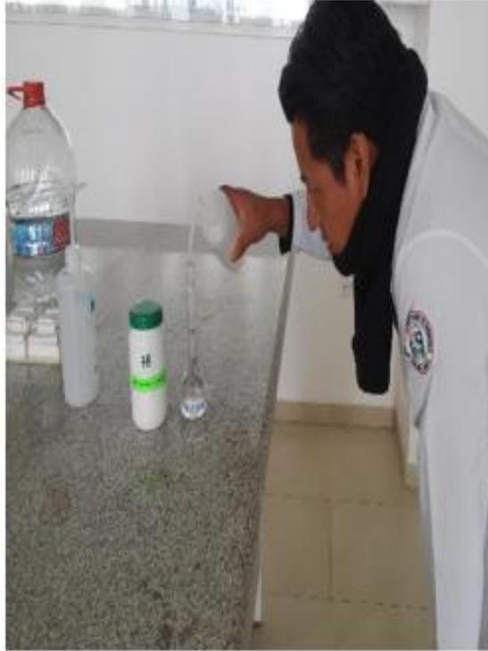
**Fotografía 1C:** Aforo de nitrato de Plomo para la obtención de una concentración de Plomo
