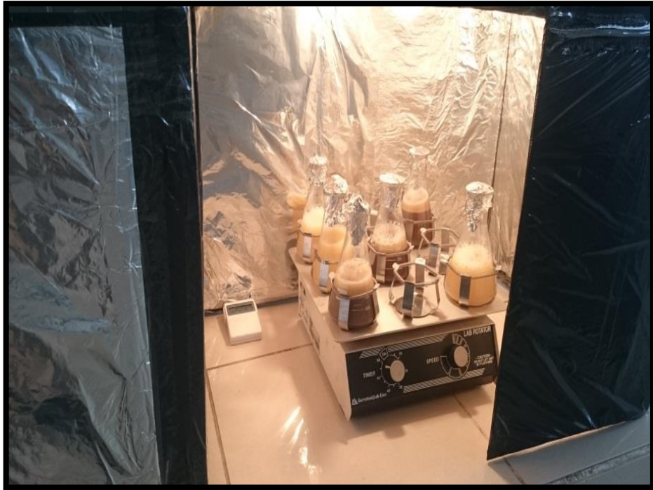
14. Cámara de calor con medio líquido inoculado con S. cerevisiae y A. niger
