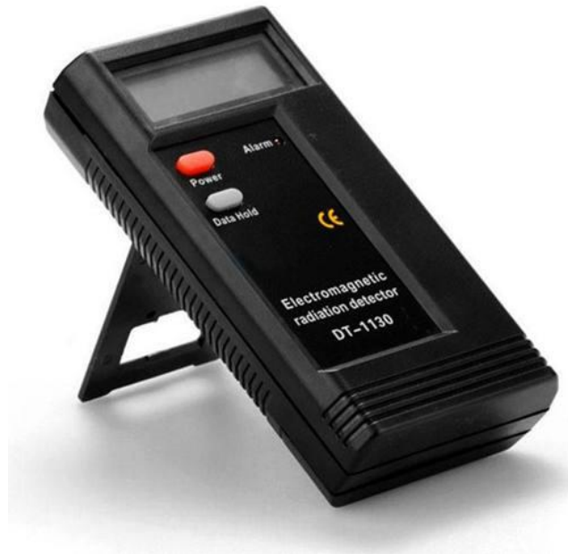
Figura 4-2: Detector de campo eléctrico
