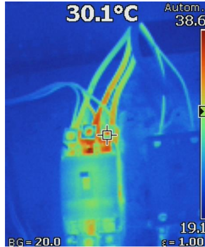
Figura 10-3 Tableros de potencia: a) Contactores para niquelinas; b) Imagen cámara termográfica de contactores en funcionamiento; c) Breaker de protección motor; d) Imagen cámara termográfica Breaker protección motor.
