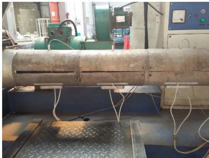
Figura 5-3 Barril o cañón que contiene el tornillo sin fin
