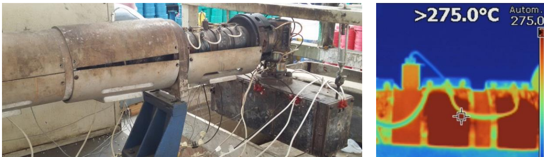
Figura 9-3 Husillo con niquelinas: a) Niquelinas con niveles de temperatura; b) Imagen termográfica.
