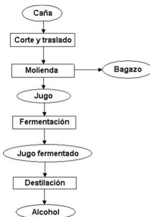
Gráfico 1. Diagrama de flujo de la elaboración del aguardiente.
