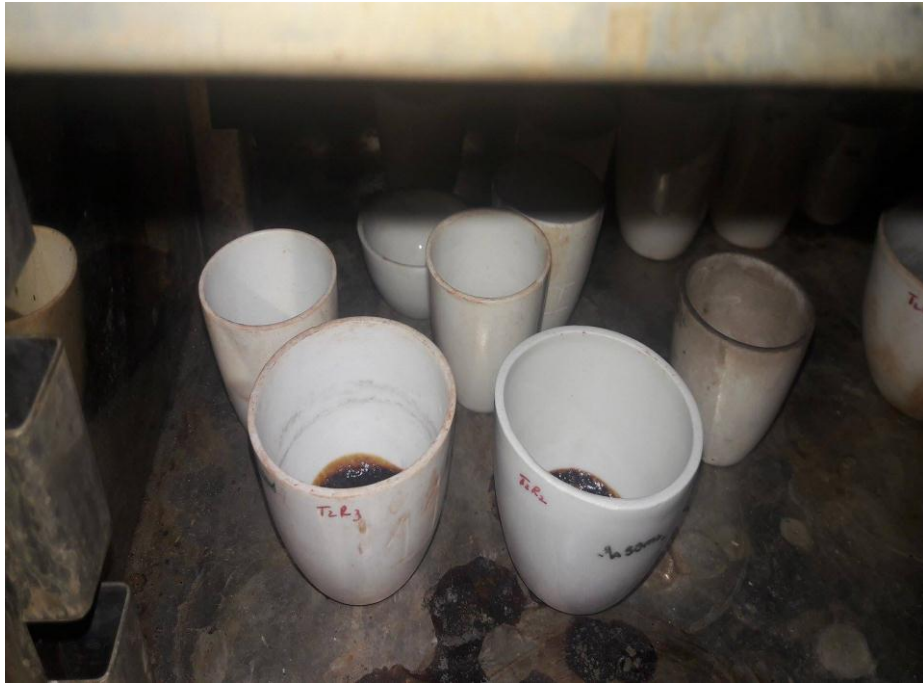
Figura 9. Determinación de humedad.
