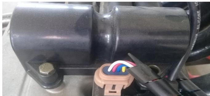
**Figura 2-4. Conexión de la bobina de encendido**
