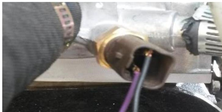
**Figura 9-4. Conexión del sensor ECT**
