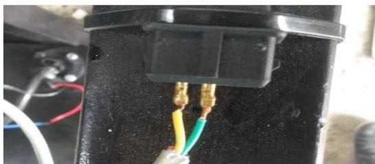
**Figura 7-4. Conexión del sensor CKP inductivo**
