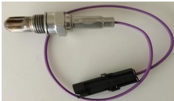
**Figura 16-3. Sensor O2 Chevrolet Corsa 1.4**
