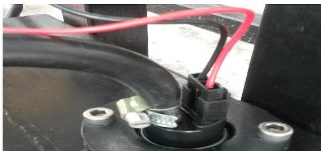
**Figura 3-4. Conexión de la bomba de combustible**
