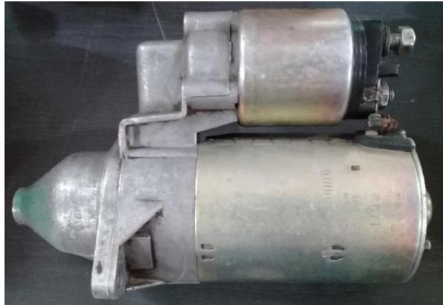
**Figura 6-3. Motor de arranque Chevrolet Corsa 1.6**
