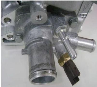
**Figura 17-2. Carcasa de la válvula termostática**
