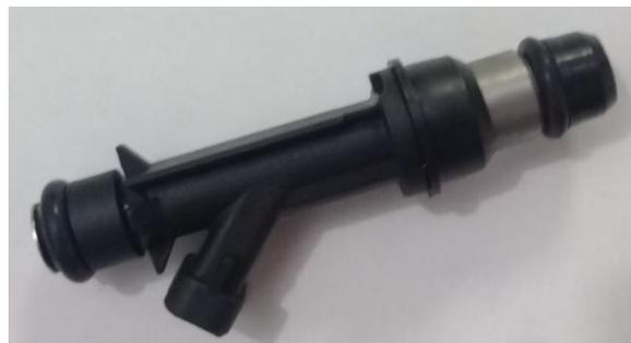
**Figura 10-3. Inyector Bosch Number 0280150996**
