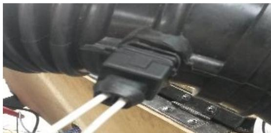
**Figura 8-4. Conexión del sensor IAT**
