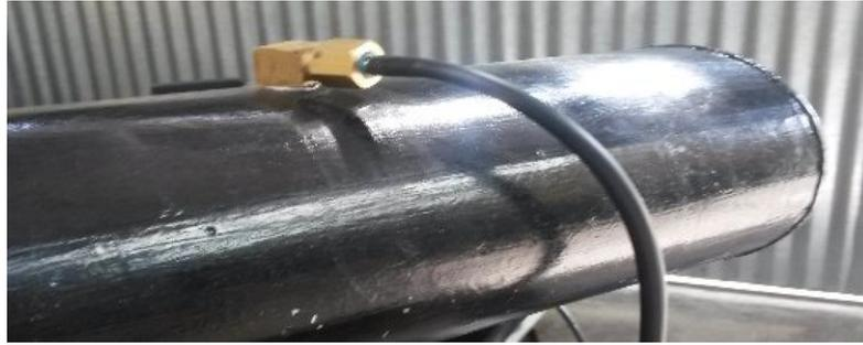
**Figura 5-4. Conexión del sensor MAP de la ECU**
