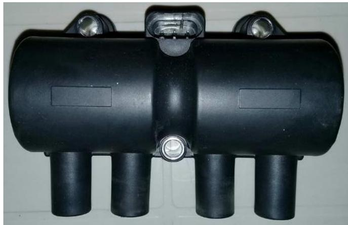
**Figura 7-3. Bobina de ignición Dis Chevrolet Corsa 1.4**
