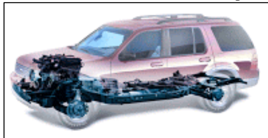
Figura 10-2. Carrocería con chasis independiente
