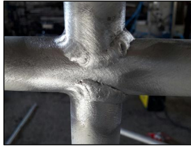
Figura 16-4. Cordones de soldadura aplicados al bastidor
