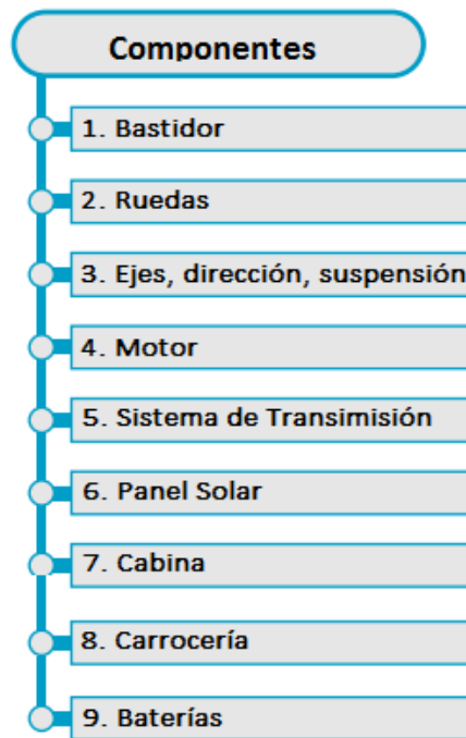
Gráfico 1-2. Componentes de un vehículo solar
