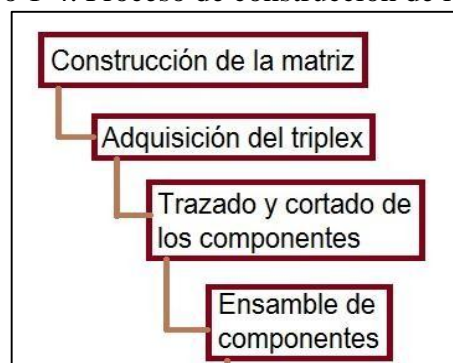
Gráfico 1-4. Proceso de construcción de la matriz
