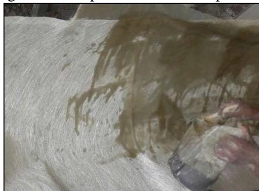
Figura 31-4. Aplicación de resina poliéster
