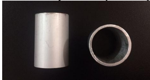
Figura 5-4. Probeta para el ensayo de compresión
