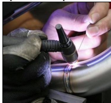
Figura 15-4. Aplicación del proceso de soldadura TIG
