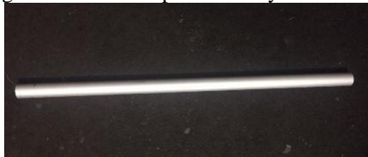
Figura 3-4. Probeta para el ensayo de tracción
