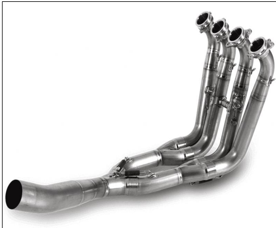
Figura 2-2. Colector de escape.
