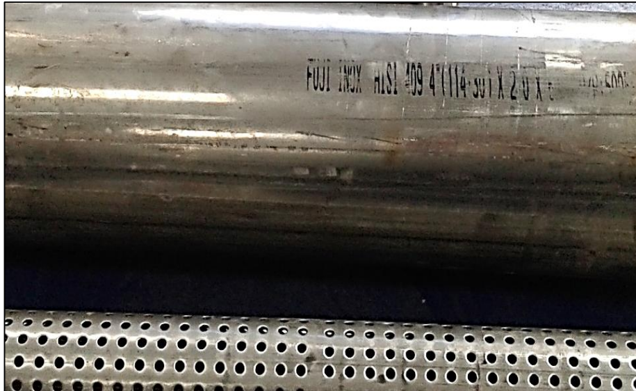
Figura 3-9. Tubería de acero inoxidable AISI 409.
