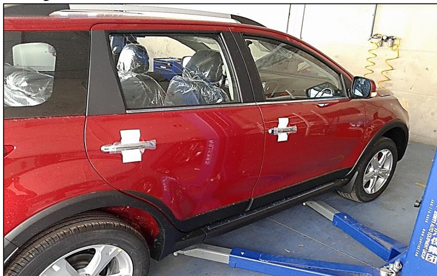
Figura 3-2. Montar el vehículo M4 en el elevador hidráulico.
