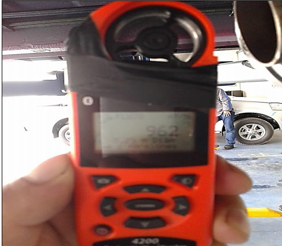
Figura 3-7. Medir la velocidad y flujo volumétrico de los gases en los tres regímenes de carga del motor.
