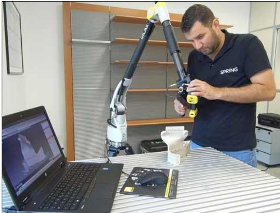
Figura 2-14. Escaneo en 3D de una pieza mecánica.
