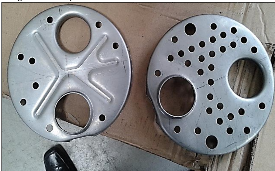
Figura 3-10. Separadores internos del silenciador del vehículo M4.
