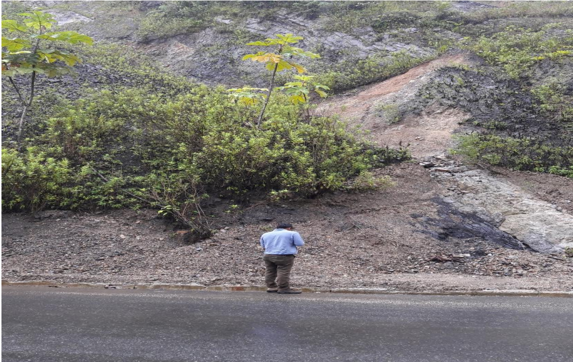
Fotografía 10-3. Falla y cambio de litología entre caliza y cuarcita. Elaborado por: Johnn Cabrera, José Solís. (2017)
