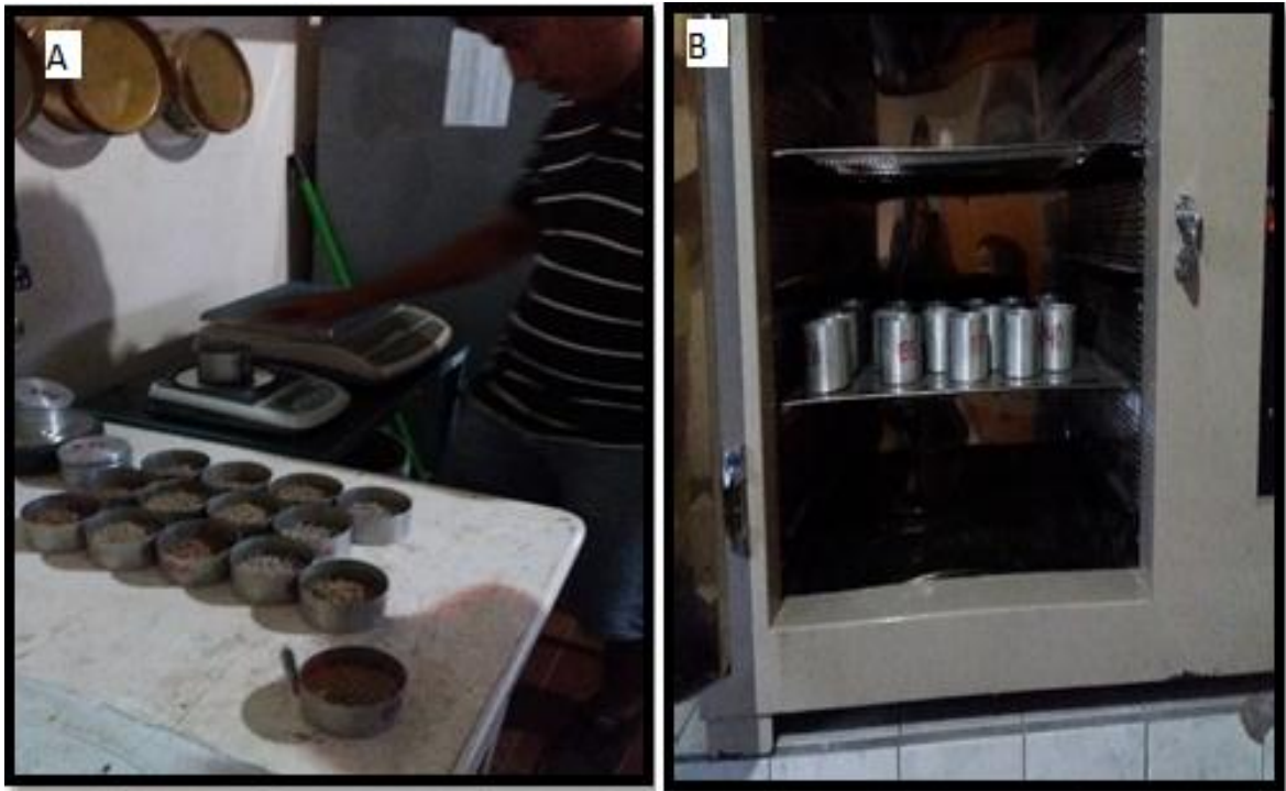
Fotografía 18-3 A) Pesado de la muestra secada en el horno B) Ingreso de las muestras en el horno para su secado.
