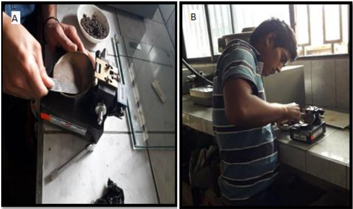
Fotografía 19-3 Ensayos de límites plástico y líquido A) Muestra homogénea. B) Utilización de casa grande.
