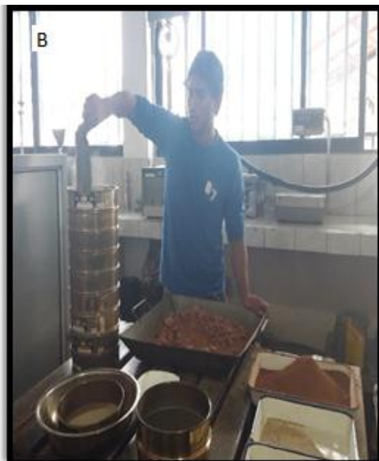
Fotografía 17-3 A) Ensayo granulométrico B) Tamizado de la serie fina
