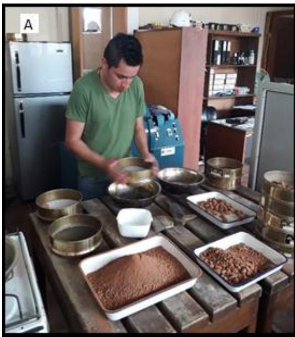
Fotografía 17-3 A) Ensayo granulométrico B) Tamizado de la serie fina
