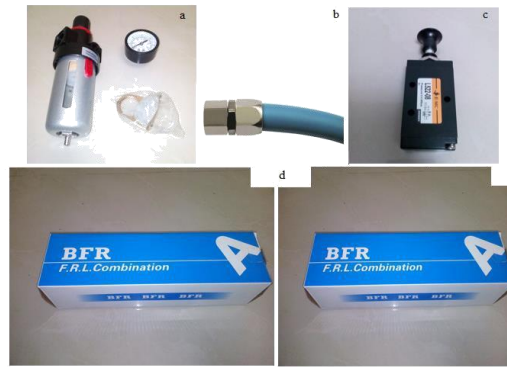
Figura 17-4. a) Filtro, b) cañerías de distribución, c) válvulas de mando, d) actuadores Fuente: Autores
