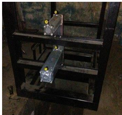
Figura 18-4. Montaje de actuadores neumáticos Fuente: Autores
