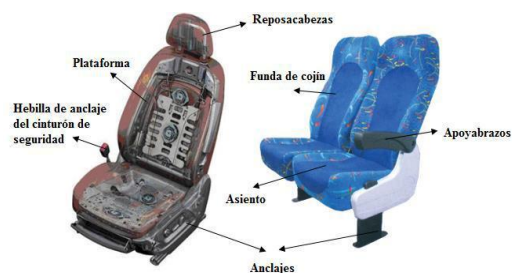
Figura 2-2. Partes constitutivas de un asiento automotriz
