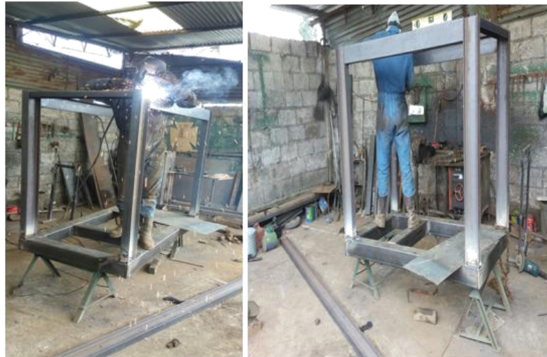
Figura 11-4. Perfiles IPN soldados verticalmente a la base Fuente: Autores
