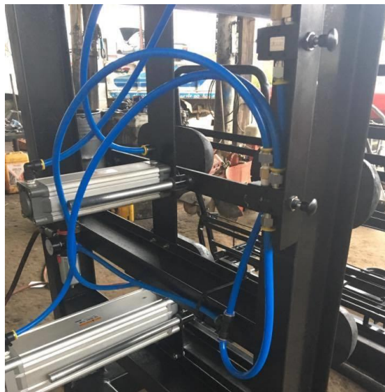
Figura 20-4. Válvulas de mando de control Fuente: Autores
