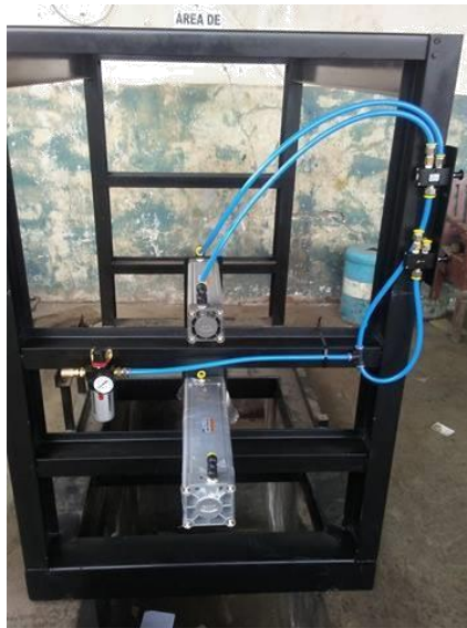
Figura 19-4. Red de distribución de fluido Fuente: Autores
