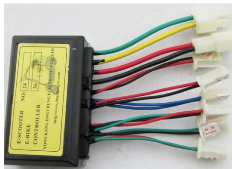
Figura 26-3: Controlador universal 36V 250W: MOD-2033084781 Fuente: http://www.minimotospeed.com/controladores.html
