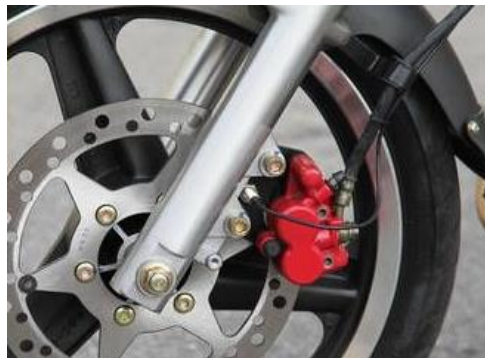
Figura 35-3: Sonda tacómetro magnético Pic-Up instalado Fuente: http://www.minimotospeed.com/velocimetro1.html
