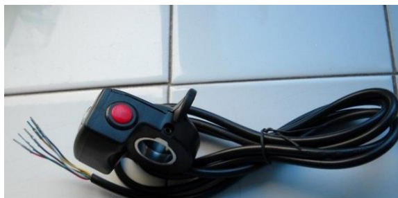
Figura 13-3: Acelerador Wuxing 24V / 36V / 48V de puño Fuente: http://www.minimotospeed.com/aceleradores.html
