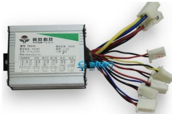
Figura 31-3: Controlador de escobillas 36v 350w Atv scooter eléctrico Fuente: http://www.minimotospeed.com/controladores.html
