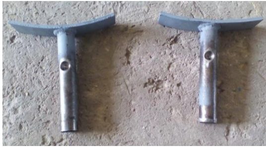
Figura 49. Guías de bloqueo del depósito contenedor de suelo.
