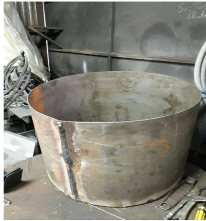
Figura 47. Depósito contenedor de suelo
