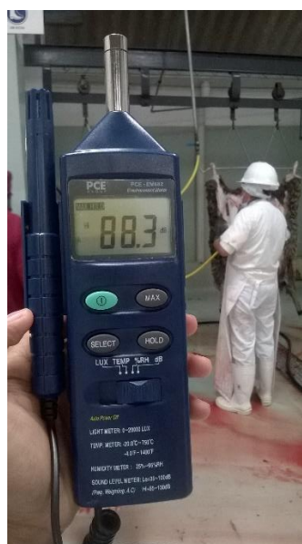
Figura. 4-16: Medidor medioambiental multifunción 4 en 1 PCE-EM882
