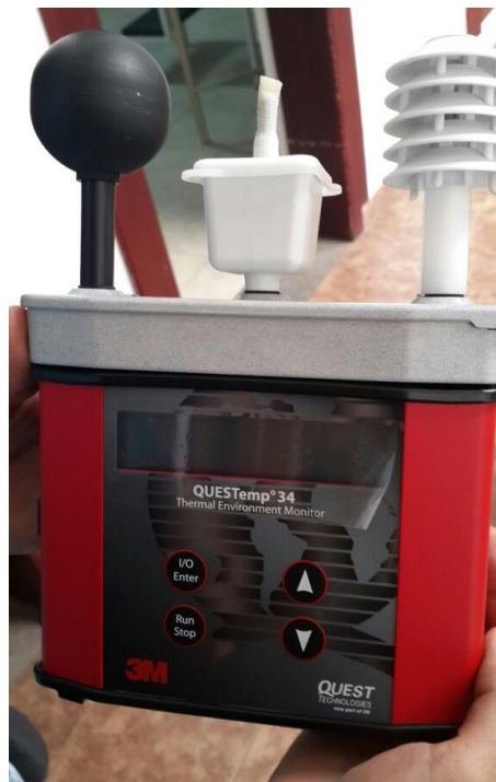
Figura. 4-19: Monitor de Área de Estrés Térmico QUESTemp™ QT-34
