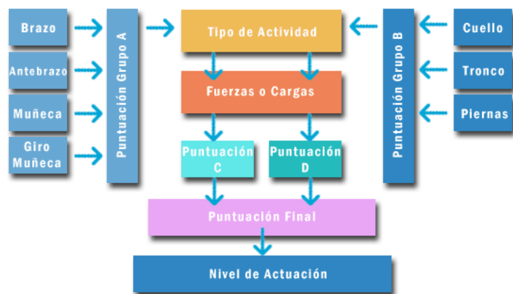
Figura. 2-6: Obtención de Puntuaciones Método RULA.
