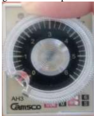
Figura 36-3. Programación temporizador analógico AH3
