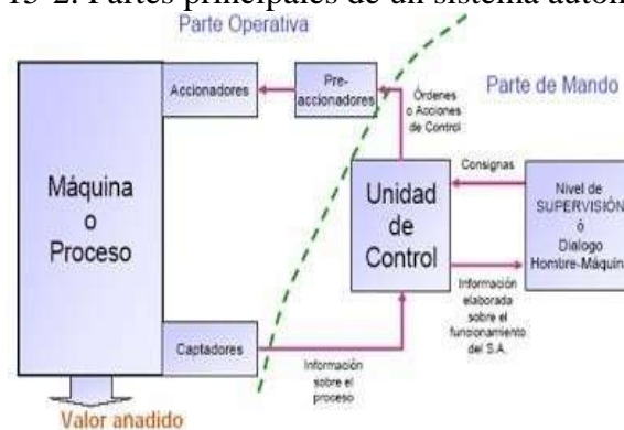
Figura 15-2. Partes principales de un sistema automatizado.
