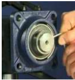
Figura 11-4. Mantenimiento en chumaceras
