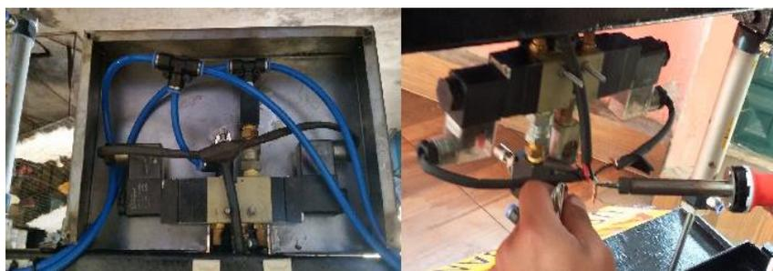
**Figura 18-2 Instalación sistema neumático**
