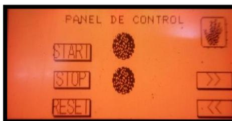
**Start:** En función manual, mantenga presionado el **botón start** para bajar la placa superior para su posterior prensado.
