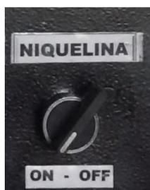
**Niquelina on-off:** seleccione el estado de la niquelina es decir encendido y apagado de la resistencia eléctrica para el planchado del cuero.
