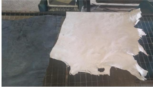
**Figura 2-3 Planchado a 100°C, calidad buena**
