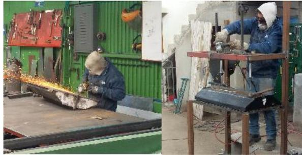
**Figura 4-2 Masillado y lijado de la estructura**
