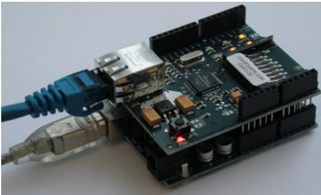
Figura 4-3: Ensamblado del dispositivo electrónico ethernet shield Realizado por: (Sánchez Wilian 2017)
