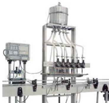
**Figura 8.2: Llenadora automática por gravedad.**
