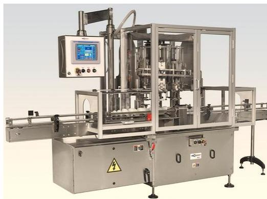
**Figura 7.2: Llenadora automática volumétrica.**
