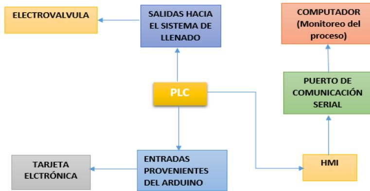
**Figura 18.4: Diagrama del sistema de control.**
