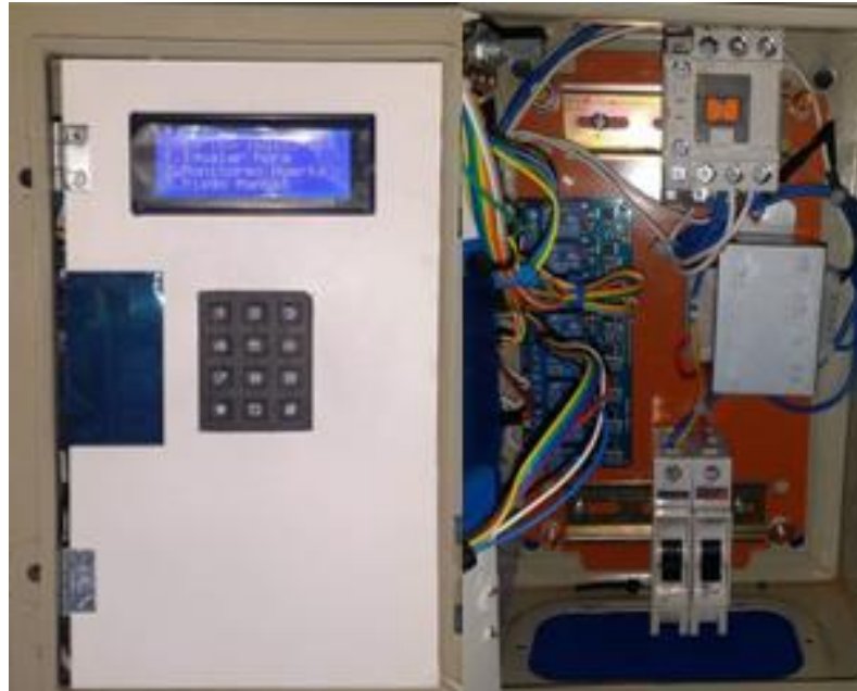
Figura 24-2: Módulos de recepción y potencia Realizado por: ARCOS, Daniel. 2017
