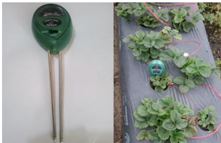
Figura 1-2: Higrómetro de suelo analógico Realizado por: ARCOS, Daniel. 2017
