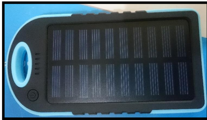
Figura 5-2: Cargador solar. Realizado por: ARCOS, Daniel. 2017.
