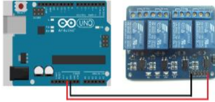
Fig. 3. Alimentación con una sola fuente
