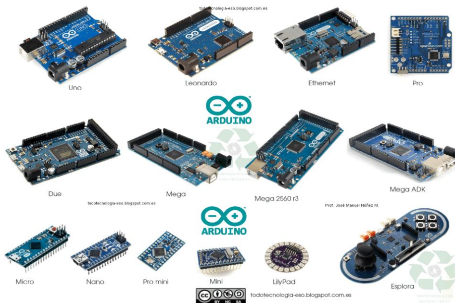
Figura 1-1: Tipos de tarjetas Arduino Fuente: INGENIO TRIANA, 2016
