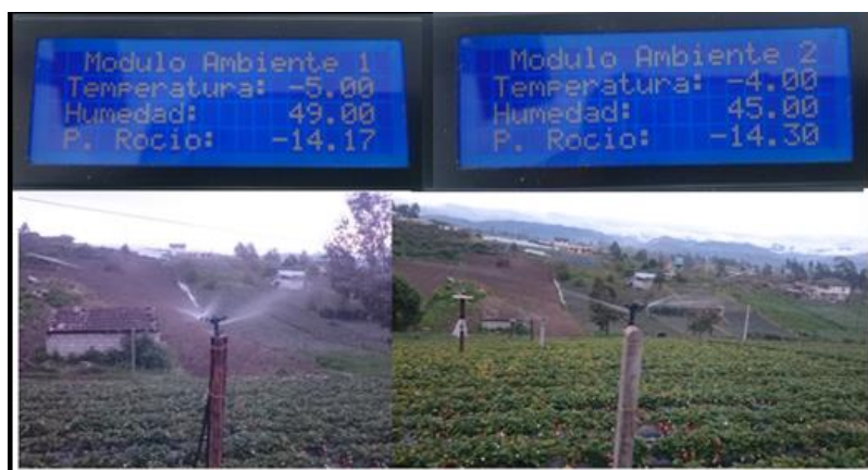
Figura 15-3: Activación de riego por aspersion Realizado por: ARCOS, Daniel. 2017
