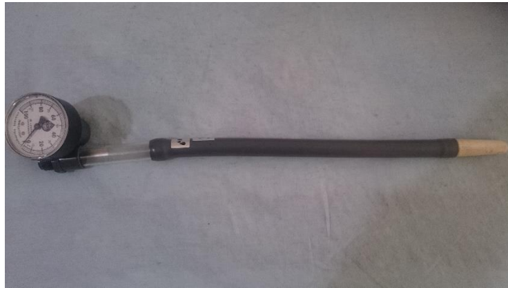
Figura 14-2 Tensiómetro de suelo A.M.I GAUGE Realizado por: ARCOS, Daniel. 2017
