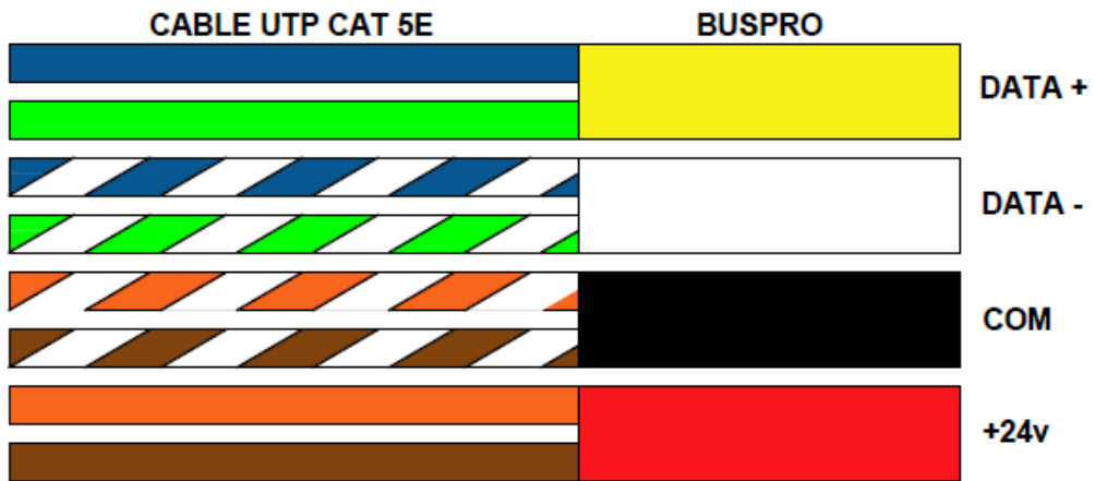
Figura 27-1. Conexión de cable UTP Cat 5E a Buspro Realizado por: Chacha, E; Maldonado, H. 2017
