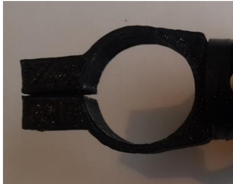
Figura 126-4: Base del mango de sujeción impresa en ABS
