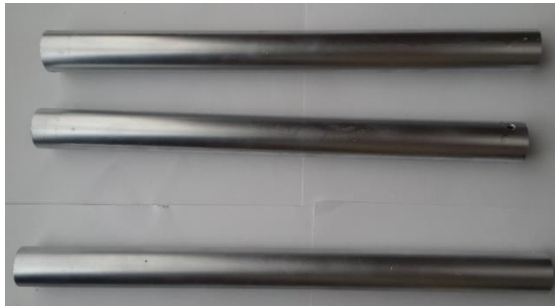
Figura 138-4: Perfiles de aluminio 1204 de 330mm y 380mm Fuente: Autor
