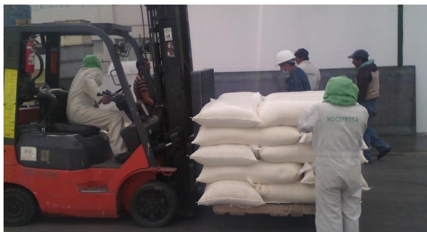
Figura N°. 34 Falta de Señalización y Luces de Seguridad en el Montacargas
