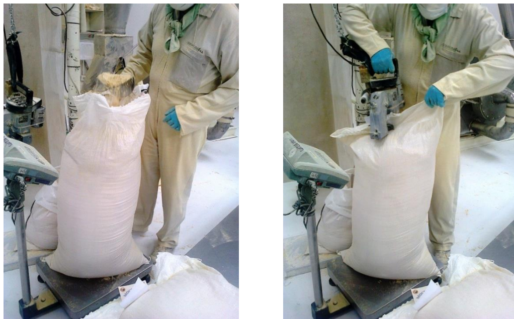
Figura N°. 18 Pesaje, etiquetado y sellado del producto
