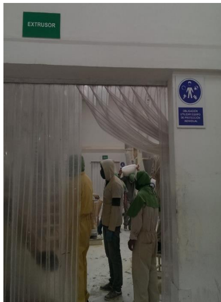
Figura N°. 60. Señales de Acción Obligatoria del Área de Extrusor
