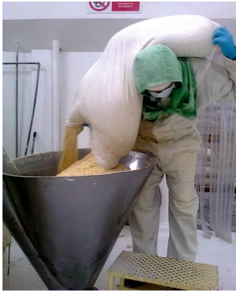
Figura N°. 12 Tolvas de recepción de materia prima
