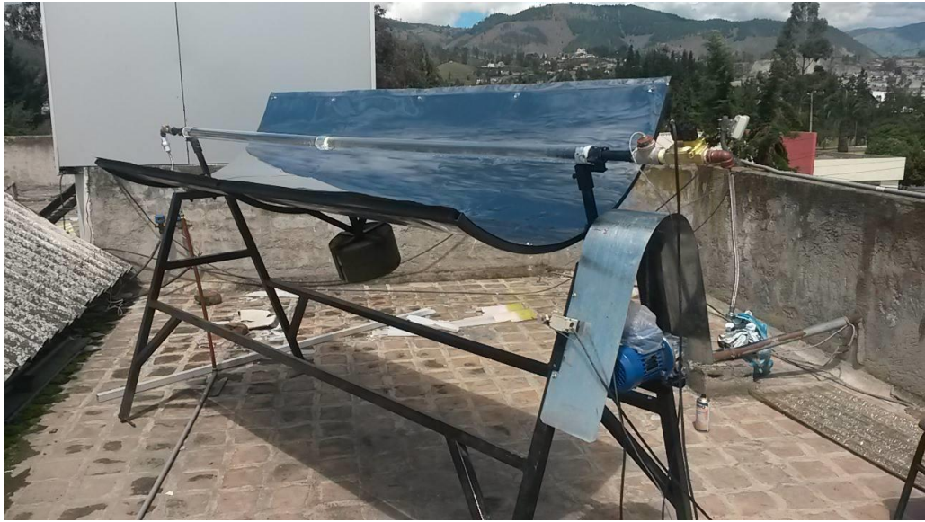
Figura 44-3.- Calentador Solar Cilíndrico Parabólico
