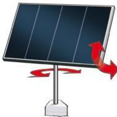
Figura 5-2.- Sistema de seguimiento solar a dos ejes
