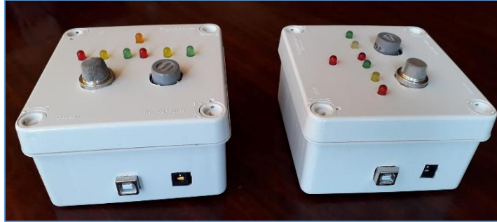
Figura 15-2. Nodos Routers Sensores armados. Realizado por: SEGURA Alex, 2017
