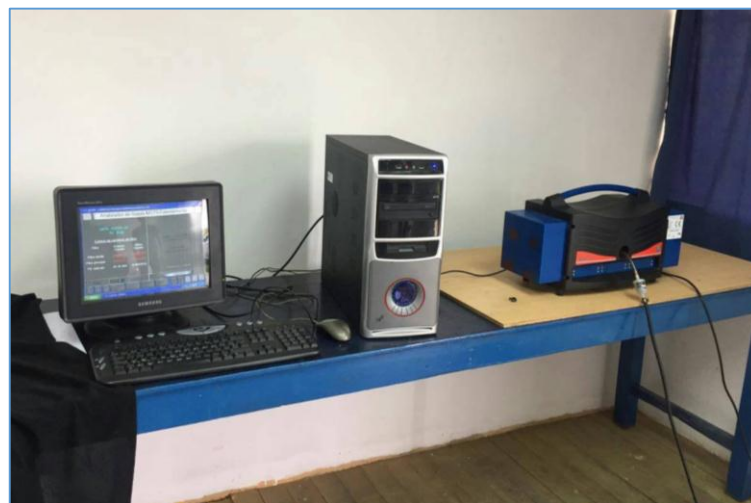
Figura 3-3. Preparación de equipo MGT-5. Realizado por: SEGURA Alex, 2017
