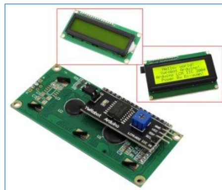
Figura 12-2. Pantalla LCD I2C. Fuente: (Llamas, 2016)
