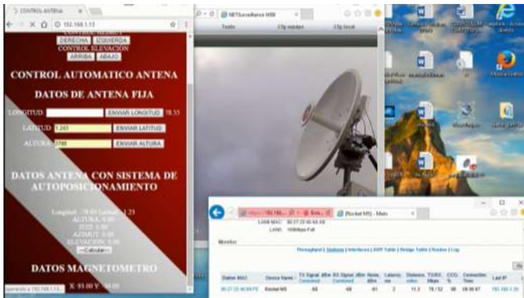
Figura 55-3: Nivel de señal del radioenlace implementado
