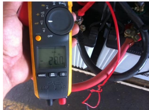
Medición del voltaje de la batería con el motor funcionando
