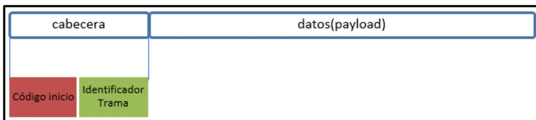
**Figura 10-1** Estructura paquete elemental o paquete PES
