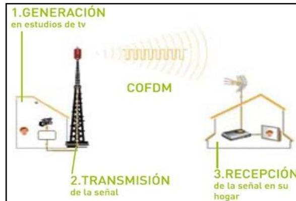
**Figura 3-1** Transmisión de señal de TDT.
