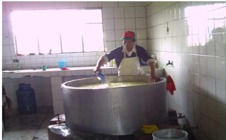
FOTOGRAFÍA 5. PROCESO DE PASTEURIZACIÓN
