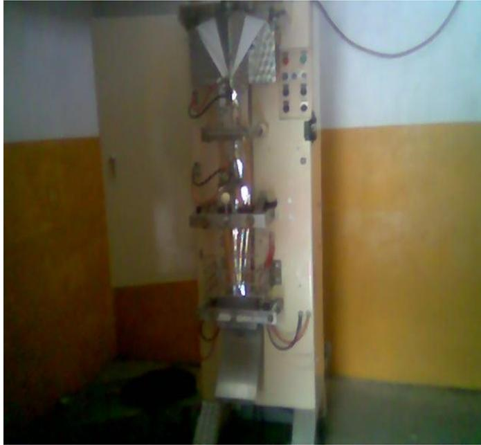
La envasadora que se utiliza dentro de la empresa tiene una ancho de 70 cm por un alto de 2.3 m.
