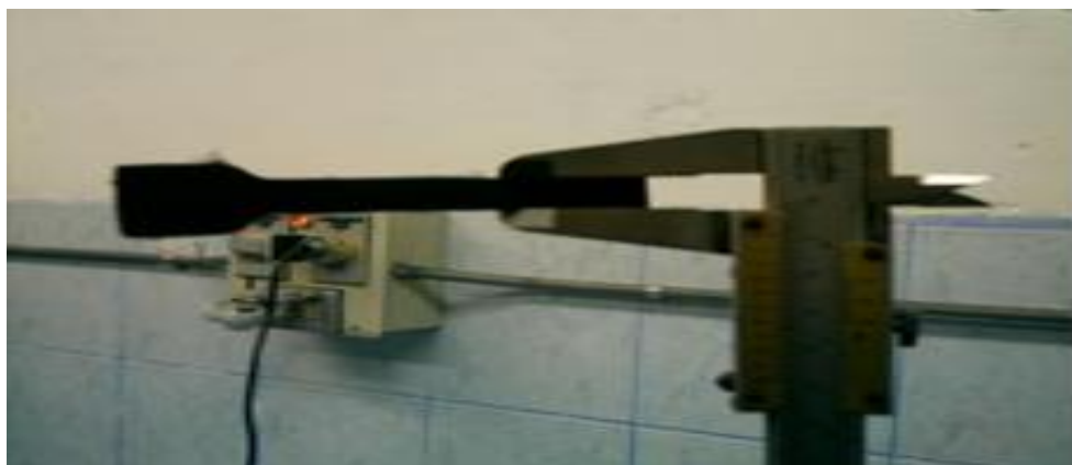
Fotografía 3. Medición de la longitud inicial del cuero.
