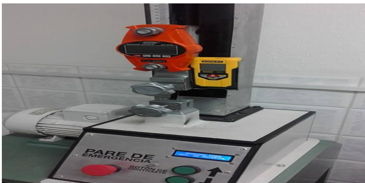
Fotografía 1. Partes de un equipo para realizar la medición de la resistencia a la tensión el cuero.
