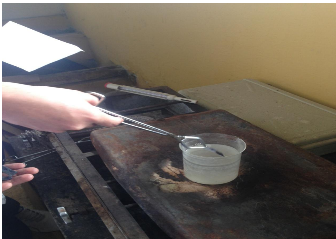
Fotografía 8. Medición de la temperatura de encogimiento del cuero caprino.
