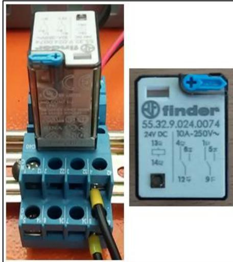
Figura 27-3 Mini relé electromecánico
