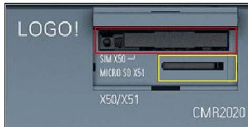
Figura 7-2 Ranuras para tarjeta SIM y micro SD
