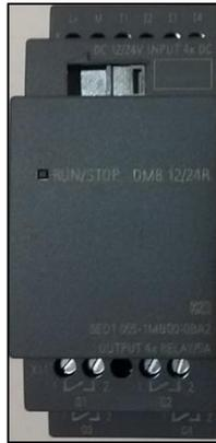
Figura 15-3 Módulo de expansión DM8 12/24R
