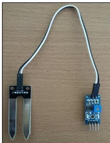
Figura 20-3 Sensor de humedad de suelo
