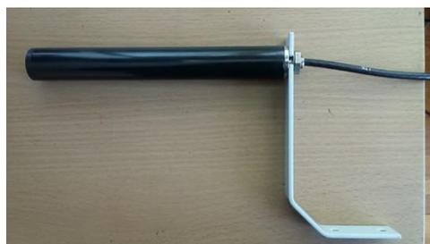
Figura 3-2 Antena GSM/GPRS para el LOGO! CMR200
