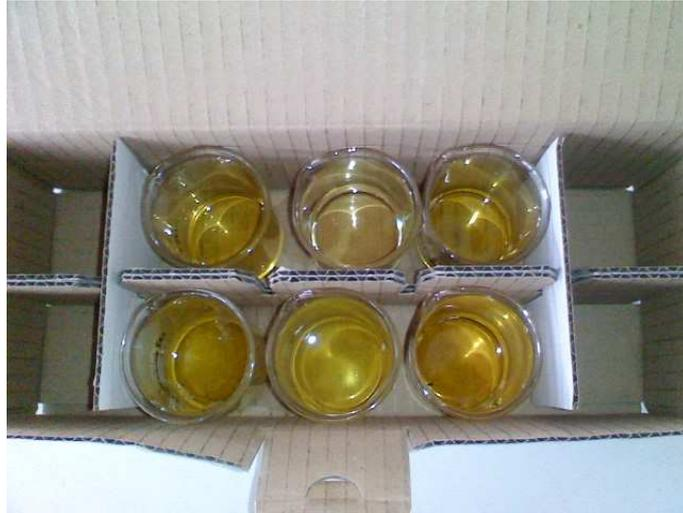
**FOTOGRAFÍA Nº 20. MUESTRAS DE ACEITES SOMETIDOS A PRUEBAS DE ESTABILIDAD A TEMPERATURA AMBIENTE**
