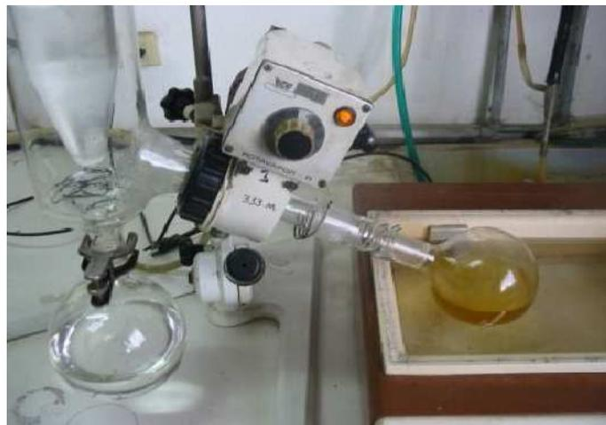
**FOTOGRAFÍA Nº 13. ELIMINACIÓN DEL SOLVENTE EN LA EXTRACCIÓN DEL ACEITE**
