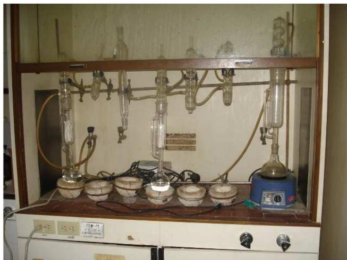
**FOTOGRAFÍA N° 10. EQUIPO DE SOXHLET PARA LA EXTRACCIÓN DEL ACEITE**
