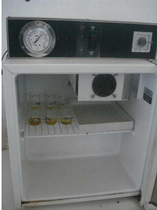
**FOTOGRAFÍA N° 22. MUESTRAS DE ACEITE SOMETIDAS A PRUEBAS DE ESTABILIDAD EN CÁMARA ACELERADA**
