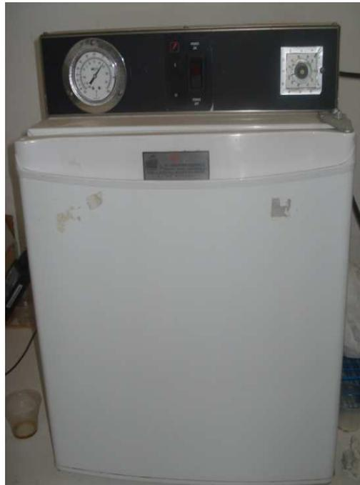
**FOTOGRAFÍA Nº 21. CÁMARA DE ALMACENAMIENTO ACELERADO**
