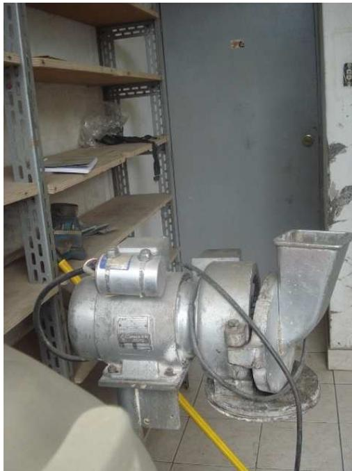
**FOTOGRAFÍA Nº 7. MOLINO USADO EN LA ELABORACIÓN DE LA HARINA DE CHOCHO PREVIA A LA EXTRACCIÓN DEL ACEITE**
