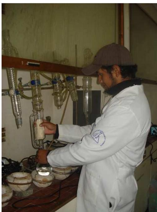
**FOTOGRAFÍA N° 11. EXTRACCIÓN DEL ACEITE DE CHOCHO EN EL EQUIPO DE SOXHLET.**
