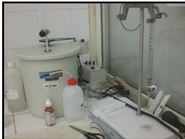
Fotografía N° 3. BOMBA CALORIMÉTRICA
