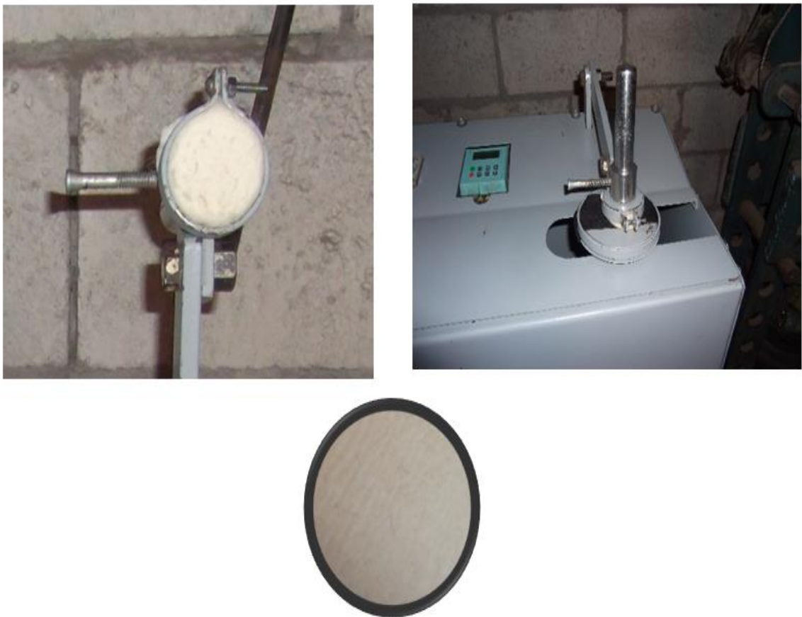
Fotografía 2. Prototipo mecánico para la medición de la resistencia al frote en seco del cuero.
