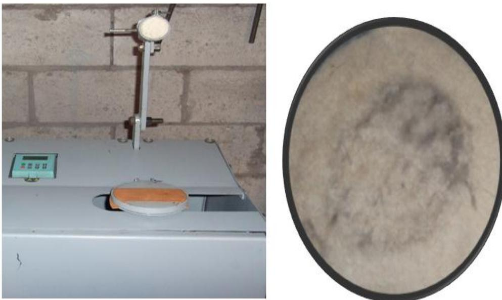
Gráfico 3. Equipo para la medición de la resistencia al frote en seco.
