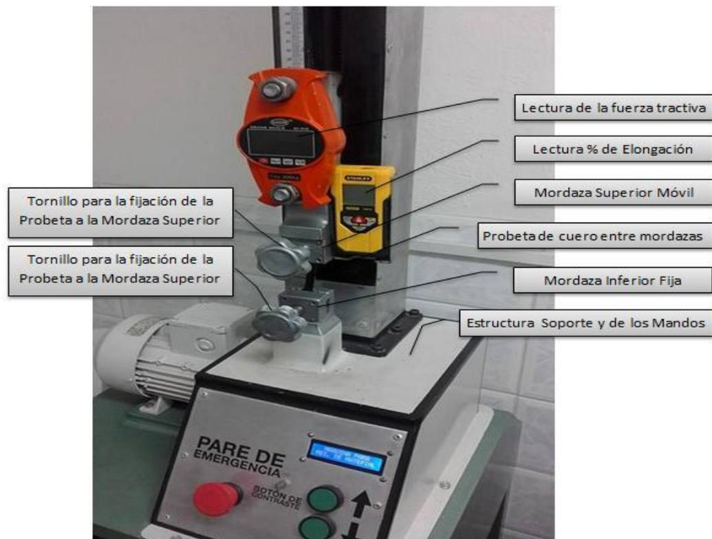
Figura 3. Máquina para el test de resistencia a la tensión.
