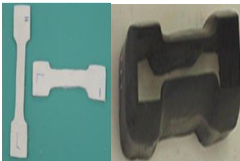
Figura 1. Forma de la probeta de cuero.
