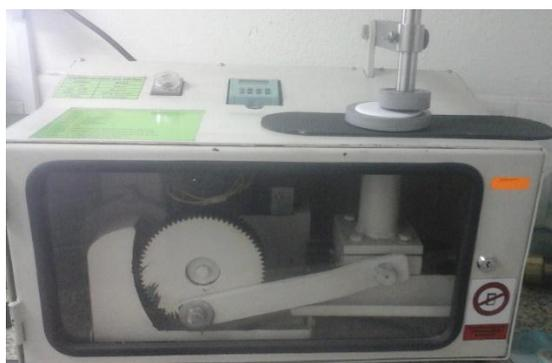
Figura 8. Equipo para medir la resistencia al frote en seco de los cueros.
