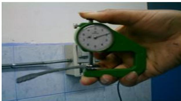
Figura 4. Equipo para medir el calibre del cuero.
