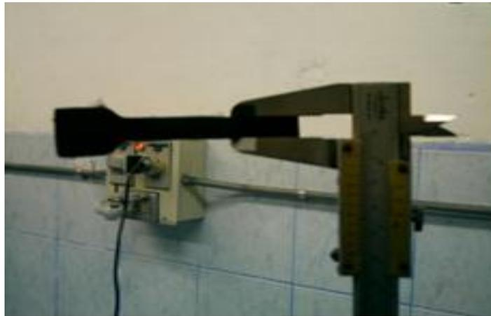
Figura 5. Colocación de la probeta de cuero entre las mordazas tensoras.
