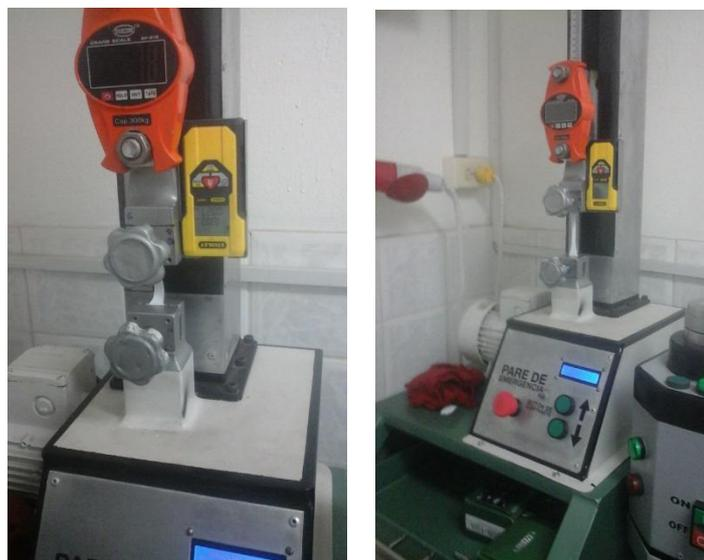
Figura 3. Equipo para el test de resistencia a la tensión.
